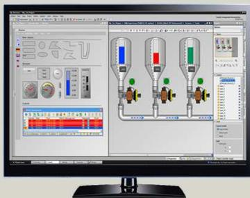
SCADA система с базовой функциональностью для использования на уровне производственных машин
